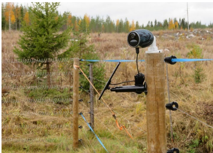
Kuva 11 (vas.) Riista- ja valvontakameroilla saadaan tehostettua laitumen valvontaa. Kuva Jaakko Alalantela. Kuva 12 (oik.) Kamerassa voidaan hyödyntää myös aurinkopaneelia. Kuva Mari Tikkunen.
